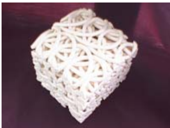
図4 根の支持体（培地）に用いるセラミックマードル
