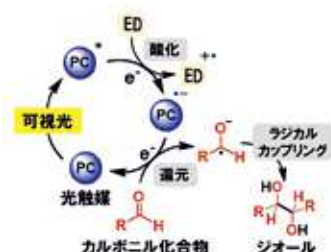
図2. 光触媒 (PC) の可視光吸収によって励起状態 (PC*) が生成し、これが電子供与体 (ED) から電子を受け取ることでアニオンラジカル種 (PC•-) へと変換される。次に、PC•- が電子をカルボニル化合物に供与することでケチルラジカル種が生成し、さらにラジカルカップリングすることでジオール体が生成する。同時に、PC•- は基質への電子供与に伴って PC へと戻ること、再び触媒反応を進行する。
