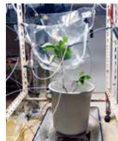
図1. 植物の炭化水素ガスの交換を測定する枝チャンパー法 特殊な透明フッ素樹脂袋で枝葉を囲み、内部に空気を通気します。
