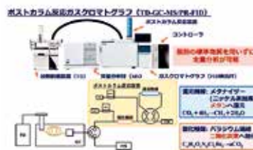
図2. 定量的ノンターゲット分析 (qNTA) に用いるポストカラム反応ガスクロマトグラフ (TD-GC-MS/PR-FID)
