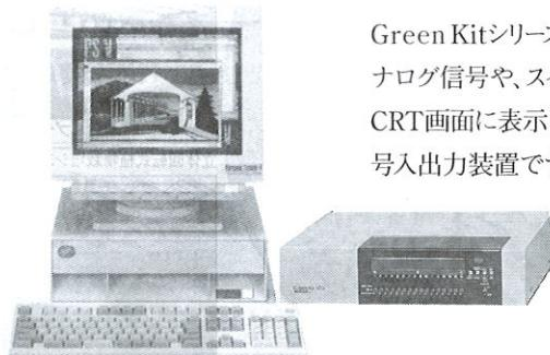
Green Kitシリーズは、電圧・抵抗・温度等の各種センサーからのアナログ信号や、スイッチ・リレー等のデジタル信号をパソコンに入力し、CRT画面に表示したり、記録し、同時に制御もできるパソコン用の信号入出力装置です。電話回線による遠隔通信も可能です。
