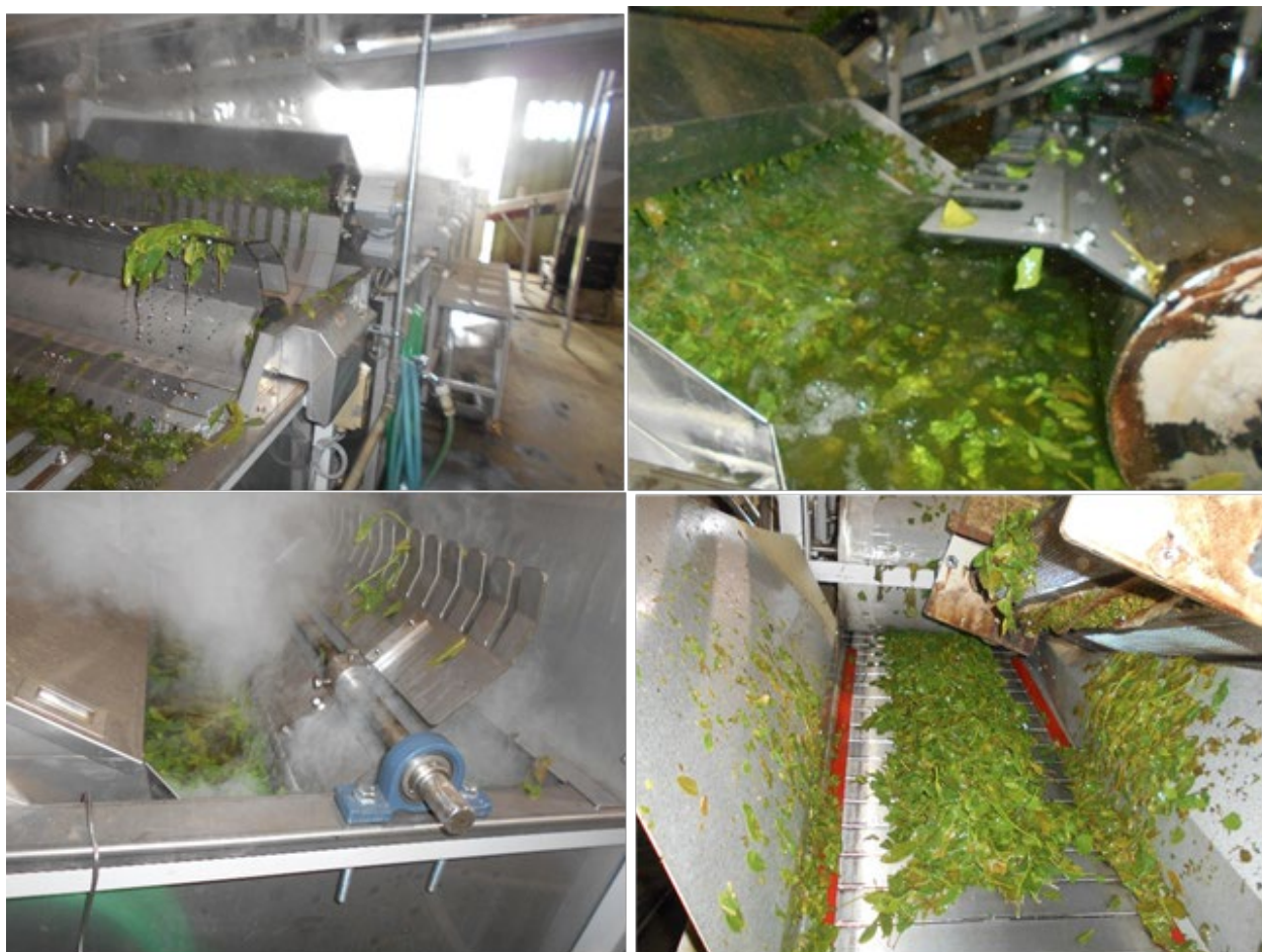
熱水バブリング方式による脱カフェイン処理
