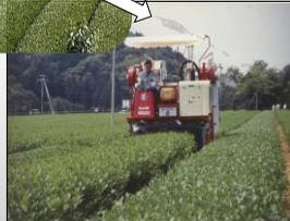
摘採は手摘みから可搬型摘採機を経て乗用型機械に変わり、著しく摘採能率を向上してきた
