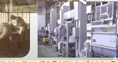
製造は手揉みから機械化され、徐々に投入量を増加させるとともに最近ではコンピュータ制御による自動化に技術革新したことで、日本独自の生産加工技術を確立し、品質の高位平準化に貢献してきた
