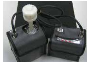
図2. 個人曝露測定用・超低騒音PM10・PM2.5サンプリングシステム
