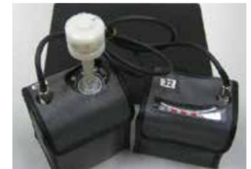
図2. 個人曝露測定用・超低騒音PM10・PM2.5 サンプルングシステム
