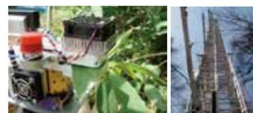
図2. 葉を測定する際用いるキュベット (左) と野外測定に利用するタワー (右)
